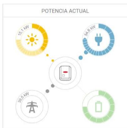
Muestra el consumo de energía en tiempo real y el suministro (en kilovatios) proveniente de ENEL Codensa y de nuestro sistema fotovoltaico.
